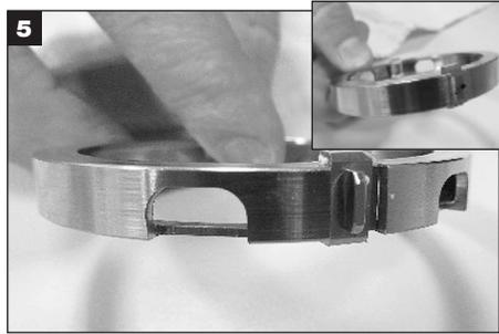
구동 채널 클립\*과 구동 채널 흐름 편향기에 그리스를 얇게 바르십시오. 두개의 컷어웨이 사이의 슬롯에 드라이브 채널 흐름 편향기를 설치합니다. 나머지 슬롯에 드라이브 채널 클립을 설치합니다.
